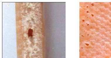
Figure 5: Porosité de surface et intérieure
