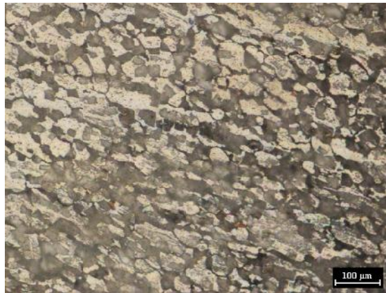
Fig. 3 : Micrographie optique du 6082 T651 d'état de l'alliage T6 Laboratoire de métallurgie (CSC Chéraga)
